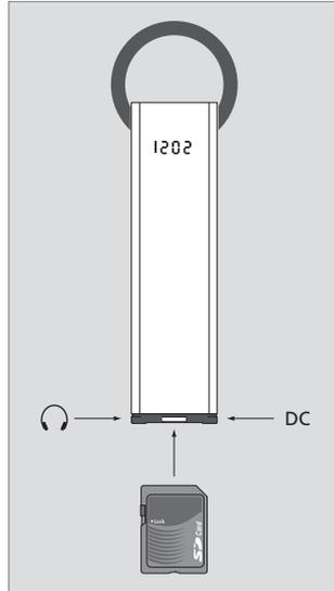
An der Unterseite befinden sich die Netzbuchse zum Akkuladen des Systems, der Speicherkarteneinschub und die Kopfhörerbuchse.
