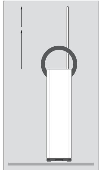
Achten Sie über dem Gerät auf ausreichenden Freiraum für die voll ausgefahrene Antenne.
